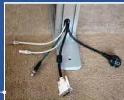
Vyústění kabelů při jejich vedení dutinou AL profiliu.
